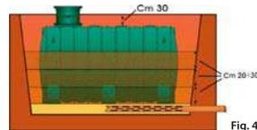
8. Lasciare il serbatoio interrato pieno di acqua col chiusino avvitato per almeno due giorni per consentire un migliore assestamento. **Prima dell'utilizzo, soprattutto in presenza di pompe idrauliche, assicurarsi che sia stato realizzato un adeguato sistema di sfiumo, in grado di evitare la creazione di vuoto, facendo affluire aria in modo costante, durante lo svuotamento del serbatoio.**
