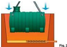
4. Livellare perfettamente il serbatoio e il suo eventuale pozzetto di prolunga. Realizzare tutte le connessioni idrauliche con il resto dell'impianto e verificare l'assenza di perdite, prima di proseguire con l'interro.
