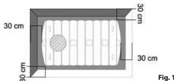
2. Creare un letto di 15-20 cm di sabbia non riciclata, disponendo al suo interno almeno un tubo di drenaggio. Livellare accuratamente la base così realizzata, avendo cura di eliminare ogni eventuale asperità. Accertarsi che la zona di appoggio non ceda sotto il peso del serbatoio pieno.
